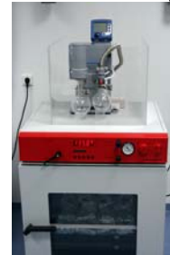
Ofen mit Vakuumanlage
